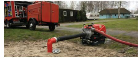
Für eine verbesserte Löschwasserversorgung wurde Ende November ein weiterer Saugbrunnen auf dem „Campingpark Oderhaff“ in Grambin gebohrt und angelegt. Mit der neuen Löschwasserentnahmestelle erhöht die Gemeinde den Grundschutz für den Zeltplatz und Strandbereich in einem Umkreis von mehreren Hundert Metern. Die Feuerwehr testete den neuen Brunnen am 4. Dezember. Dieser fördert etwa 1200 Liter Löschwasser in der Minute.
