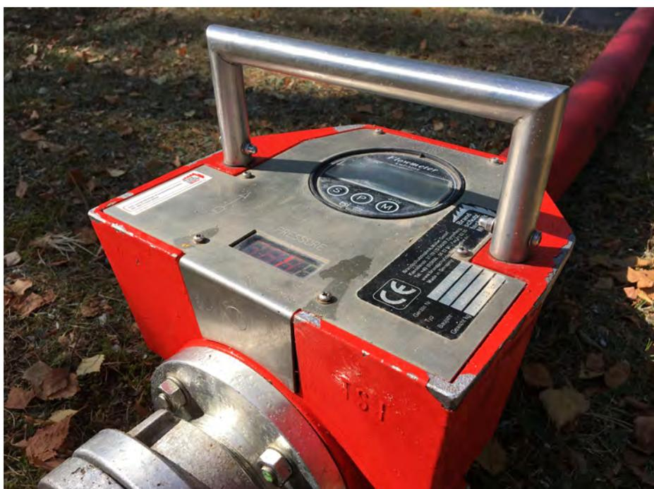
*Mit diesem Gerät wurde die Wasserdurchflussmenge gemessen.*
