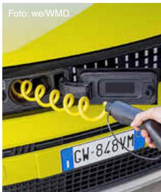
Mit dem neuen Grande Panda bringt Fiat frischen Wind in die E-Mobilität – kompakt, alltags-tauglich und mit einem echten Clou: einem integrierten Spiralkabel samt Aufrollautomatik. Schluss mit schmutzigen, verhedderten Ladekabeln! Das 4,5 Meter lange Kabel liegt sauber verstaut unter der Fronthaube – immer griffbereit und wet-
